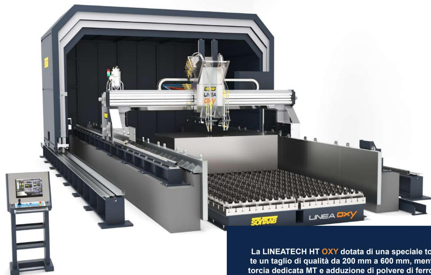
La LINEATECH HT OXY dotata di una speciale torcia MTT, consente un taglio di qualità da 200 mm a 600 mm, mentre con la seconda torcia dedicata MT e adduzione di polvere di ferro, si raggiunge uno spessore di taglio di 1000 mm.
